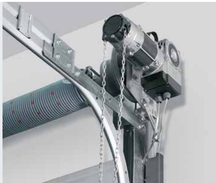
Montage standard à l'horizontale, en alternative à la verticale. Illustration avec chaîne manuelle de secours disponible en option.
